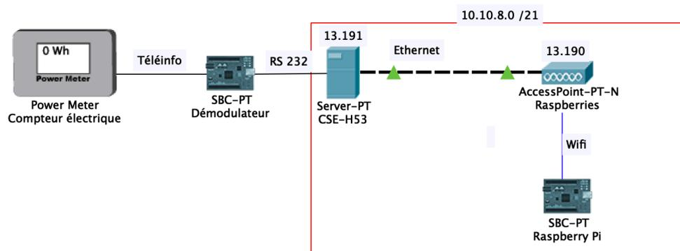
Le Raspberry Pi va se connecter périodiquement à la passerelle RS232 / Ethernet pour récupérer les trames **téléinfo**, en exécutant un programme « **tce2xml.php** » pour décoder ces informations et les enregistrer dans un fichier « **teleinfo.xml** » :
